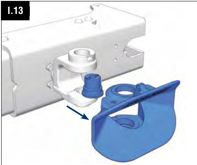
I.13 Demontage der unteren Führungsbuchse und des Kuppelkörpers (4) Dismantling of the lower guide bushing and the coupling assembly (4)
