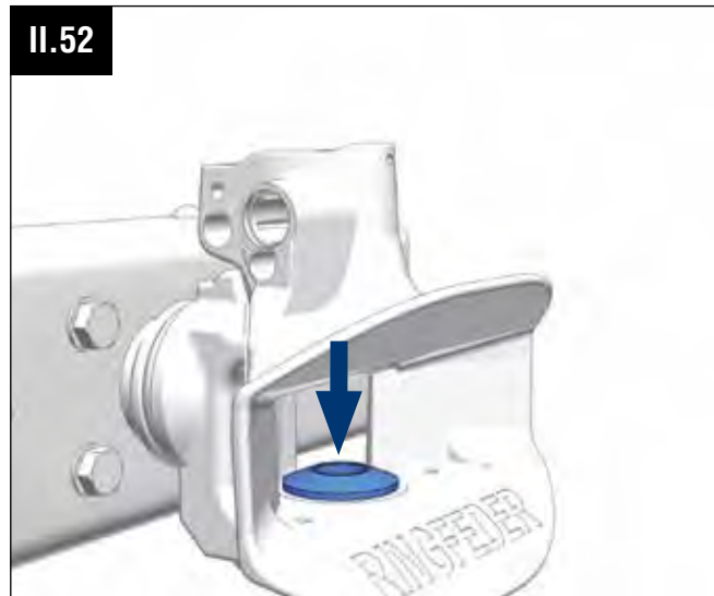
Montage der unteren Führungsbuchse (4) Fitting of the lower guide bushing (4)
