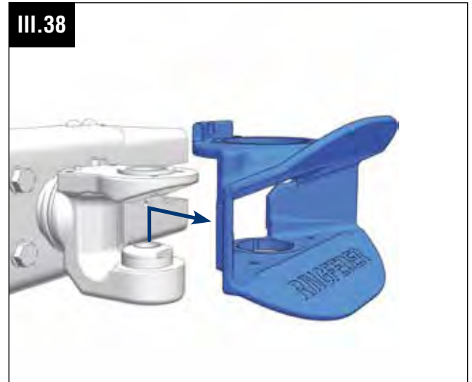
Demontage des Kuppelkörpers Dismantling of coupling assembly
