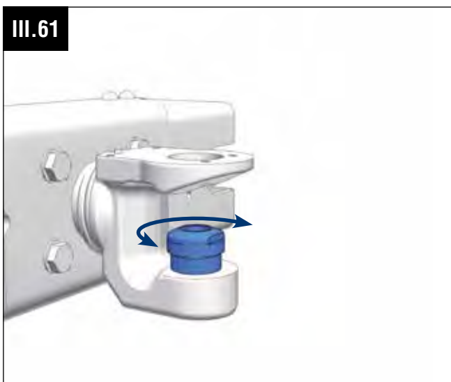
Montage der unteren Führungsbuchse (2) Fitting of lower guide bushing (2)
