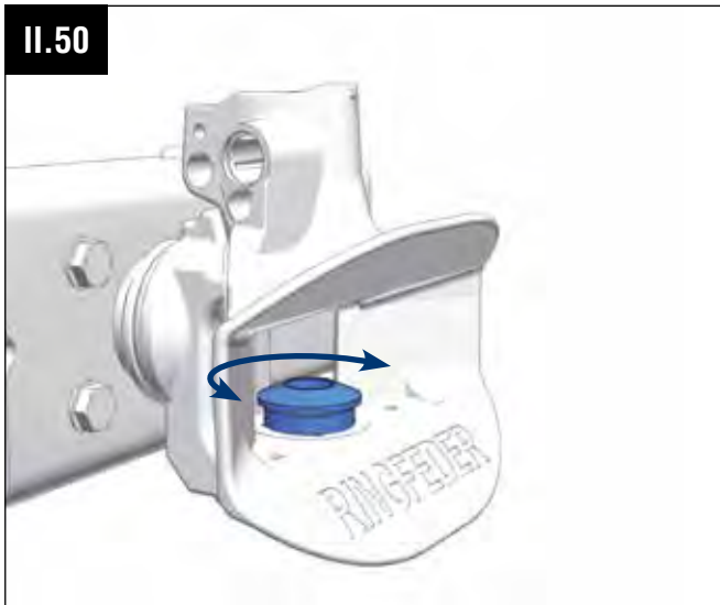
Montage der unteren Führungsbuchse (2) Fitting of the lower guide bushing (2)
