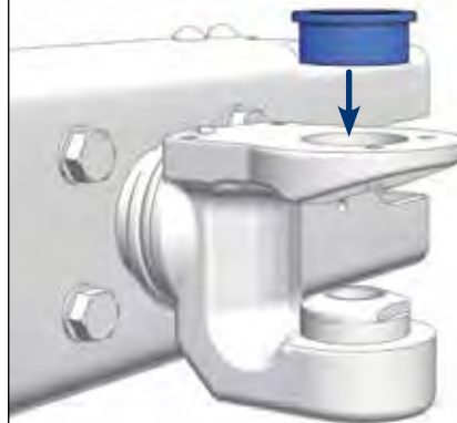
Montage der oberen Führungsbuchse (1) Fitting of the upper guide bushing (1)
