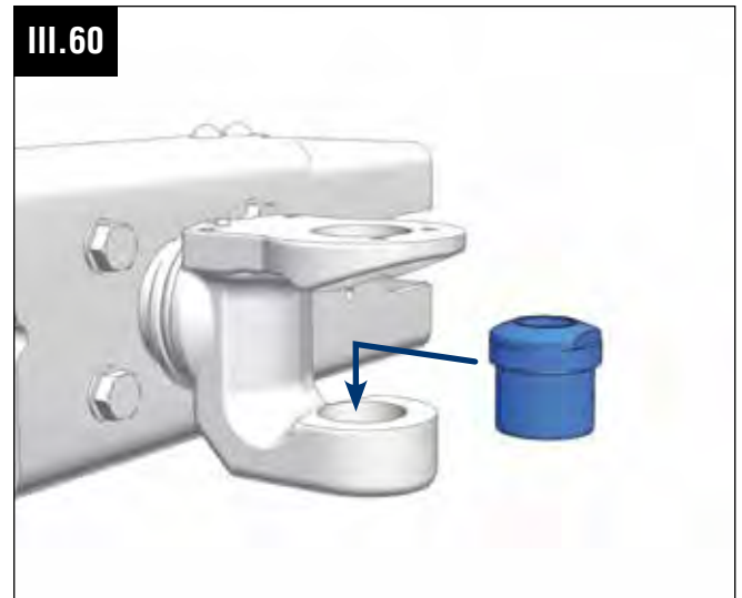
Montage der unteren Führungsbuchse (1) Fitting of lower guide bushing (1)
