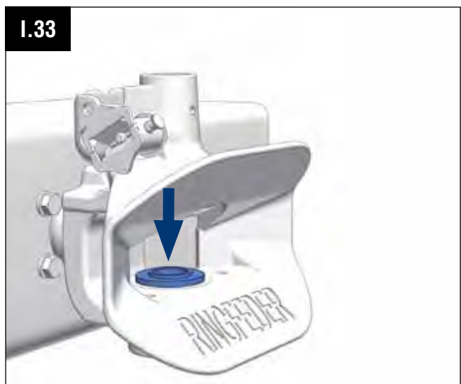
I.33 Montage der unteren Führungsbuchse (4) Fitting of the lower guide bushing (4)
