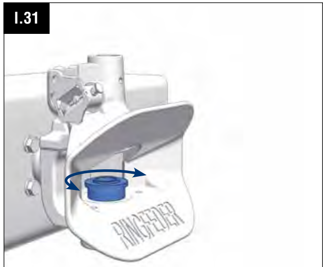
I.31 Montage der unteren Führungsbuchse (2) Fitting of the lower guide bushing (2)
